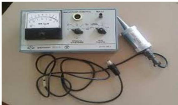
Рис. 4. Общий вид виброметра
